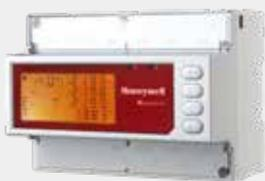
HEM 系列三相电子式多功能仪表 (DIN35mm 导轨式安装) 是一款集测量记录、电能计量、远程抄表、大屏幕 LCD 显示功能于一体的多功能仪表。本仪表可测量电压、电流、功率、功率因素和频率等多项电网参数；可计量有功和无功电能；具有单 / 复费率电能；可配置一路 RS-485 通信接口，支持 MODBUS-RTU 和 DL/T645-2007 双通信规约；可配置开关量输出功能。
